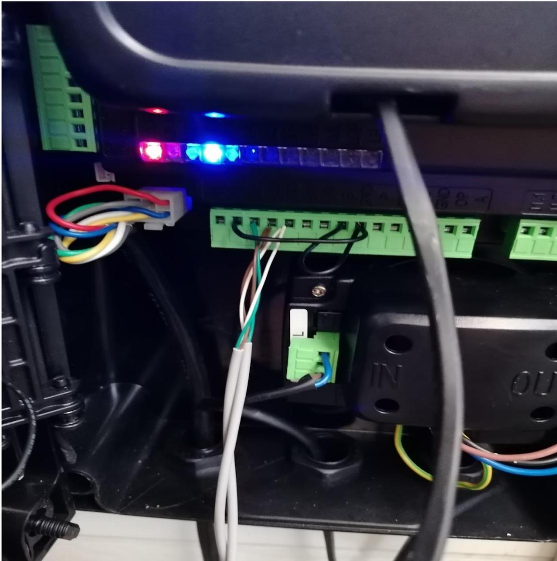
Il collegamento della fotocosta (o costa ottica), esclude di fatto l'eventuale necessità di inserimento di una resistenza 8K2.
